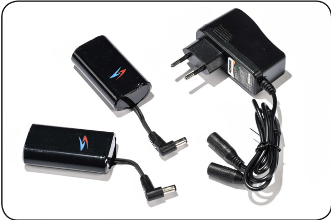
Batteries 7 Volts 2600mAh : Puissance 7.4V 2,6Ah 19,24Wh Autonomie 2h30 à 8h Poids : 100gr la batterie Dimensions : 67x35x18mm
