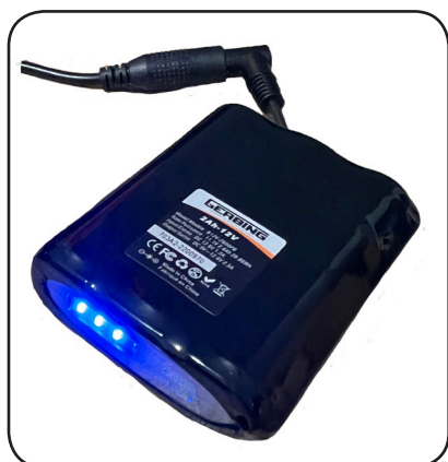
niveau de charge sur une batterie 12V - 2600mAh
